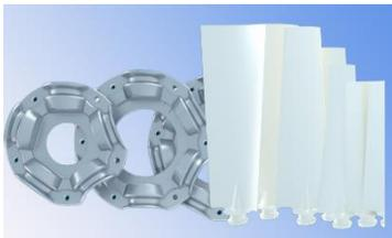
Hélice compuesta por masa central de Aluminio para 5, 9 y 16 posiciones y pala de material PAG con sentidos de flujo horario, anti-horario y reversible(\*).
